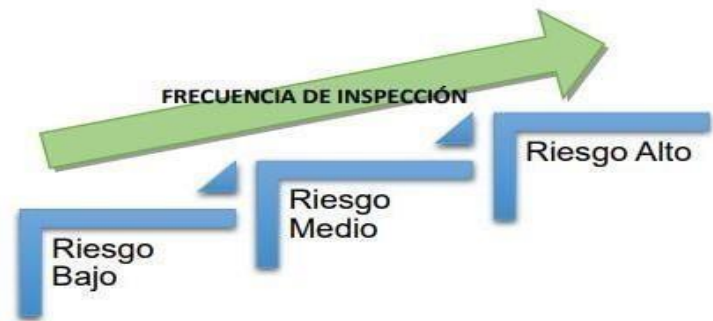
Figura 5. Frecuencias de inspección basadas en riesgo.
